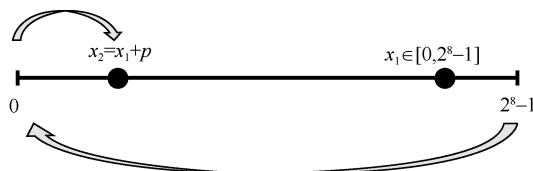
图 1 智能合约中溢出漏洞的触发原理
